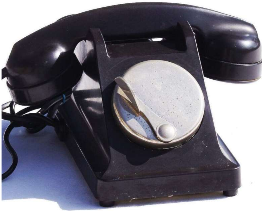
Téléphone U43 avec dynamo d'appel en façade
